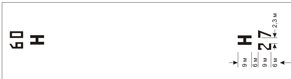
Рис. 5-3. Маркировка обозначения зоны FATO и вертодромная опознавательная маркировка для зоны FATO типа ВПП
